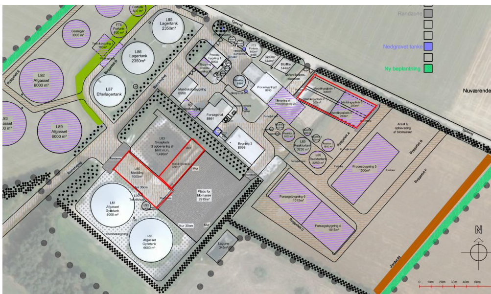
Fig 7. Planlagt projekt, placering af møddingspladser til opbevaring af dybstrøelse (markeret med røde firkanter).
