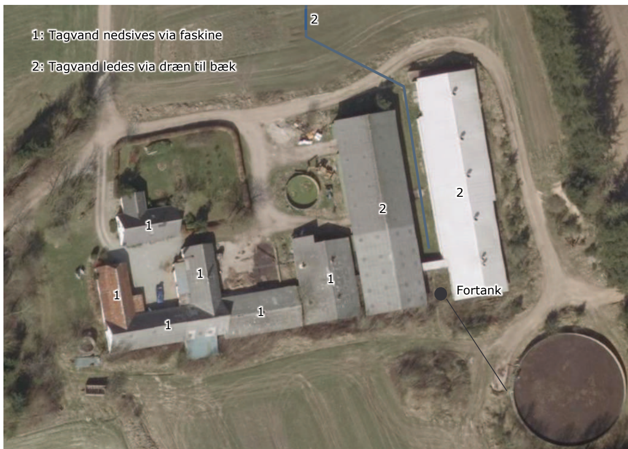
Princip for tagrender og håndtering af overfladevand
