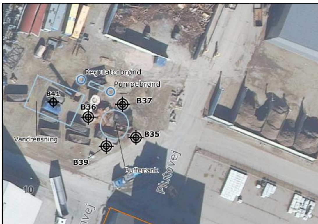
Figur 2.1 Placering af de 4 monitoringsboringer.
