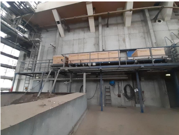
Foto 5. Transportbåndet leverer klinisk risikoaffald til indfyring.
