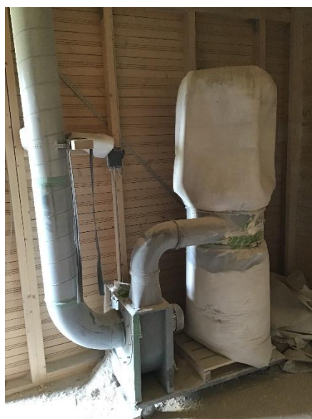
Ovenstående spåneudsug kører sammen ud i en bygning, hvor de har hvert sit filter, se nedenfor - der er ét hovedafkast fra de to udsug.
