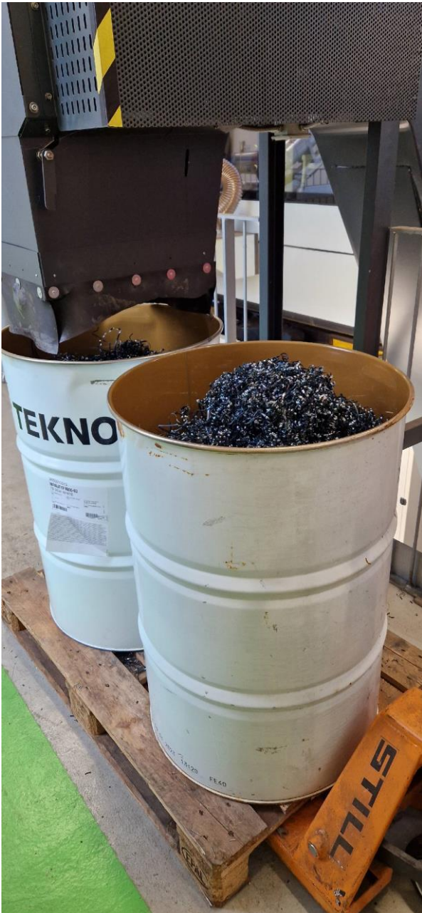
Metalspåner fra fræser ender i overdækket container.
