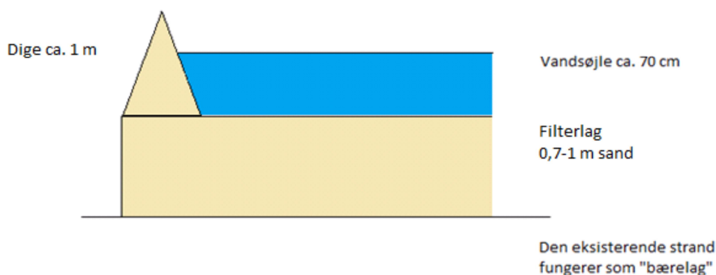
Figur 1 Skitse for opbygningen af sandfilteret (langsomfilter).
