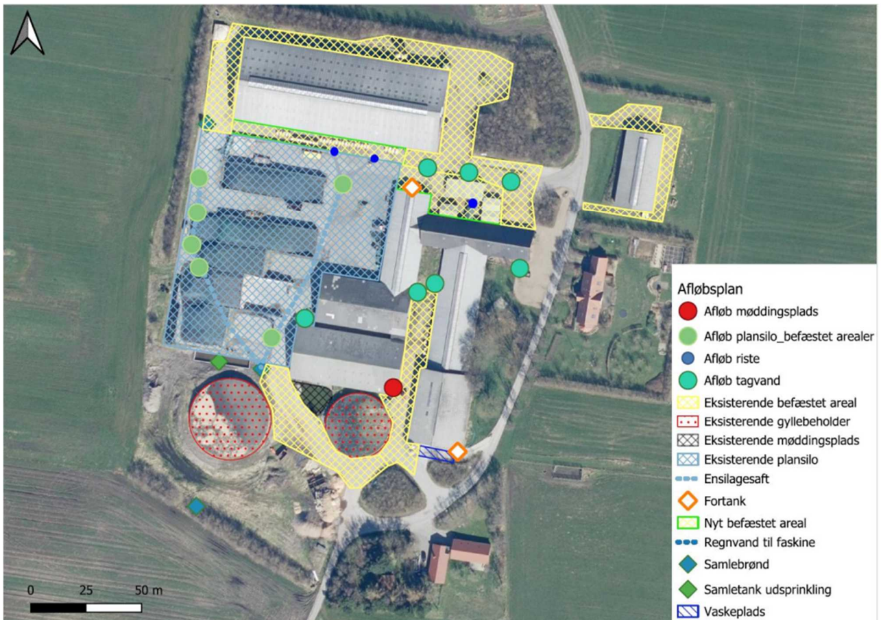
Figur 12 Ansøgers Figur 6. Befæstede arealer, som er vist med skraveringer. Rundt om bygning 4 og gyllebeholderne løber regnvandet af jorden. I de resterende skraveringer sker der en opsamling af regnvandet.
