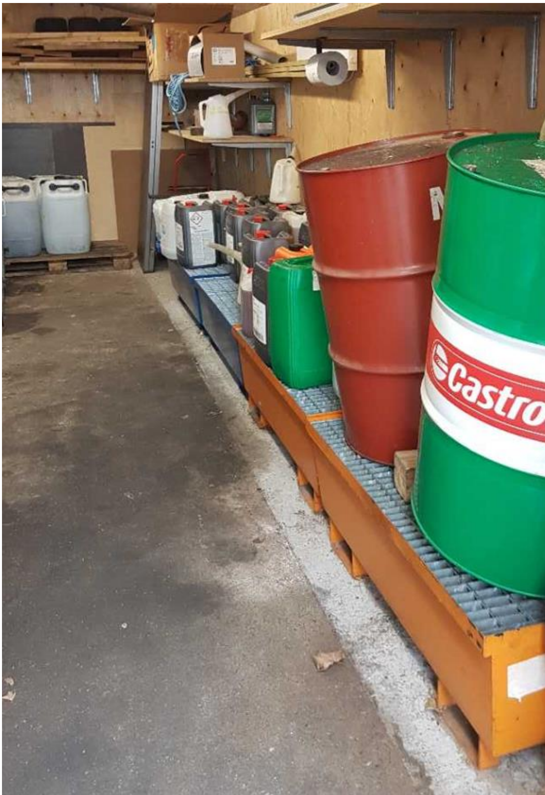
Opbevaring af råvarer på spildbakker i skur.
