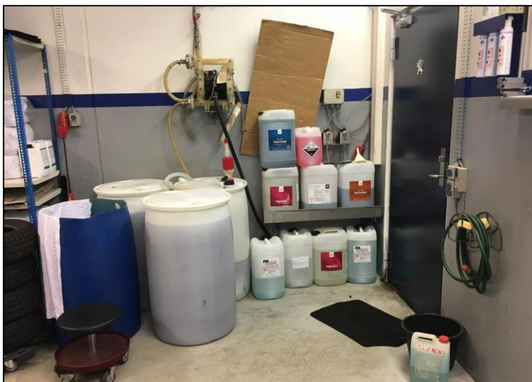
Foto af kemikalieopbevaring på betongulv uden afløb
