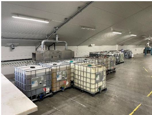
Pallettankene med indhold på fastbelægning uden afløb.
