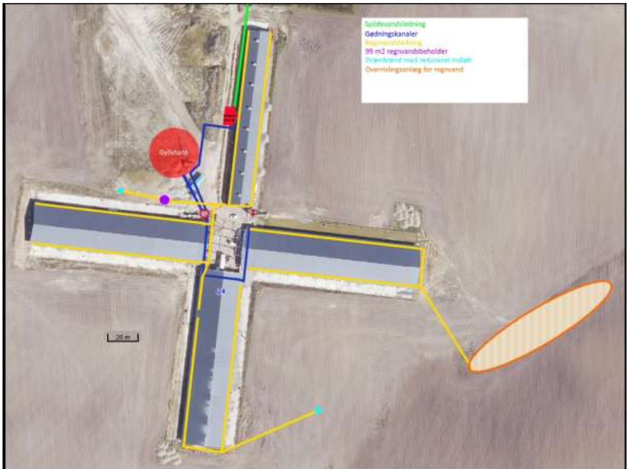
Figur 3. Placering af rørføringer (husdyrgødning, regnvand og spildevand), og hvor det forventes ledt hen.
