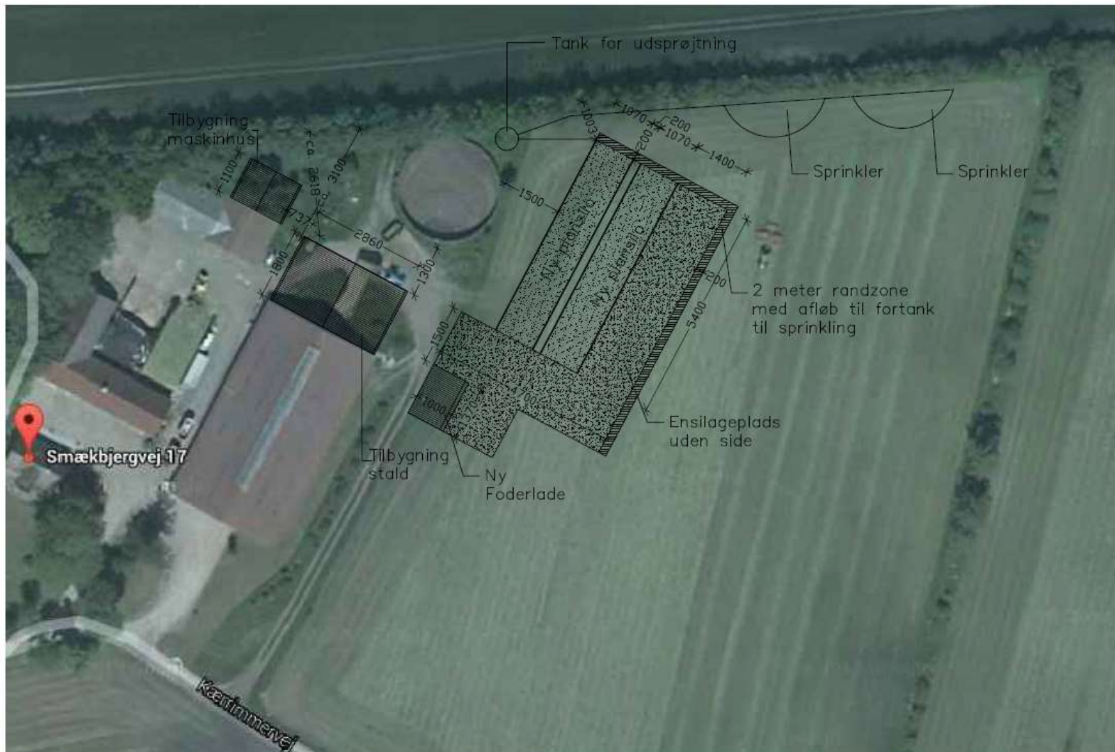
Bilag 2: Situationsplan over staldanlæg, ny plansiloanlæg og foderlade med mål. Lavet af KjargaardByg Totalentreprise.
