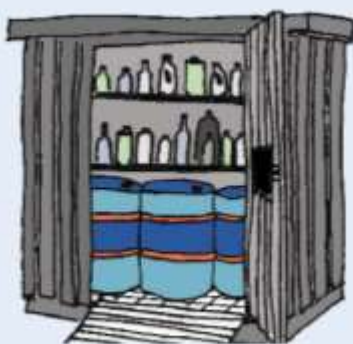
Figur 2: Udendørs opbevaring i container med dobbelt bund.
