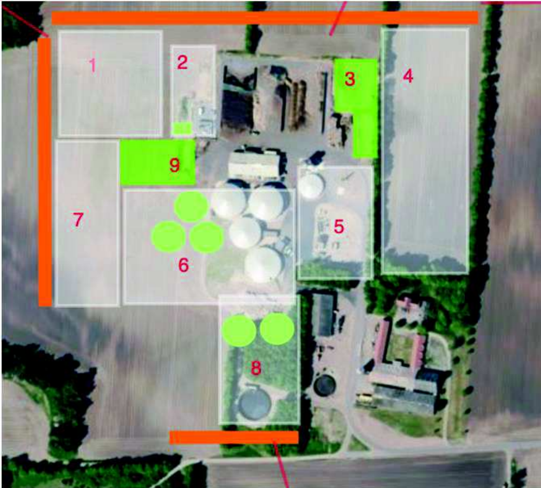
Figur 1: Principskitse med placering og byggefelt for den fremtidige indretning af biogasanlægget. Der skal etableres siloer i område 1, 3, 4, 7 og 9. Der skal etableres bygninger i område 2 og 9.
