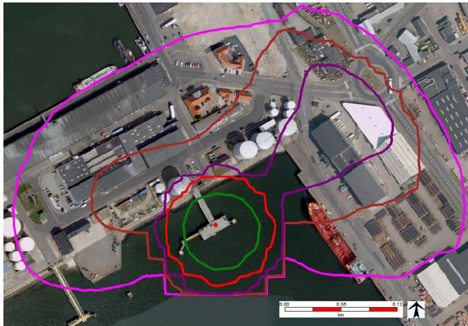
Fig. 4: Iso-risikokurver for Kosan Gas A/S' pier. Sikkerhedszonen ( 10^{-6} /år) angives med rød kurve.
