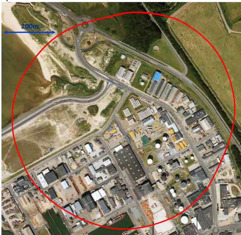
Fig. 1: Maksimal konsekvensafstand ved fyldestation for personskade pba gasskybrand og varmestråling. Rød kurve er foreningskurve.
