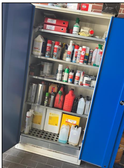
Div. produkter i skab med spildsikring
