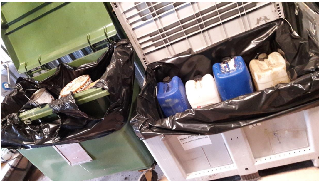
Figur 4: Rum med farligt affald. Øverst til højre: tromle med spildolie placeret på gulvet i rummet til farligt affald. Øverst til venstre: palletank løftet fra gulvet. Nederst: hjulede affaldscontainere indeholdende spande og dunke med farligt affald.
