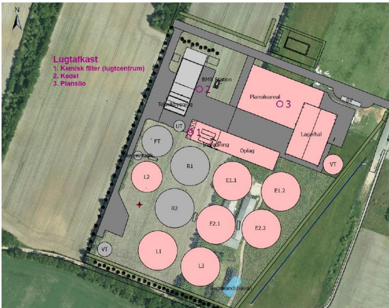
Figur fra ansøgningen: Emissioner til luft. De runde cirkler, markeret med 1, 2, 3, angiver emissionsafkast fra anlægget.
