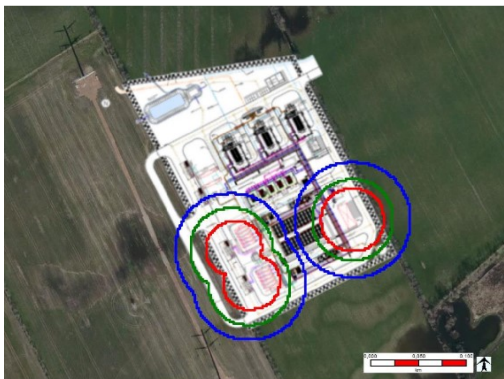
Figur 2-5 Sumkurve for varmestråling fra pølbrand (Blå: 4,7 kW/m 2 personskade; Grøn: 15 kW/m 2 Dominoeffekt, langvarig påvirkning; Rød: 35 kW/m 2 Dominoeffekt, kortvarig påvirkning).
