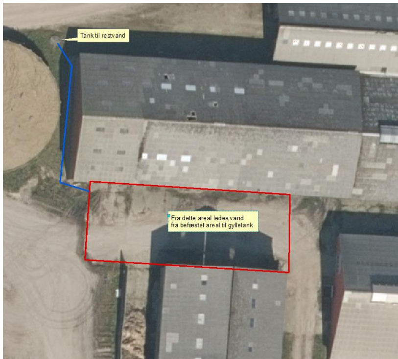
Figur 10. Afløb fra befæstet areal til gylletank.
