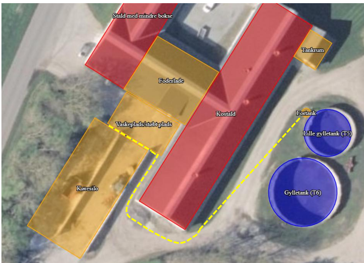
Opsamling af overfladevand fra køresilo og vaskeplads/støbt plads
