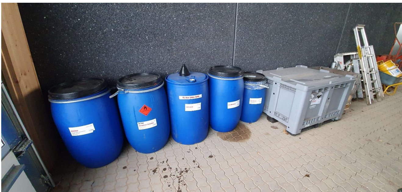
Tønder med flydende farligt affald står på utæt belægning og uden spidsikring.
