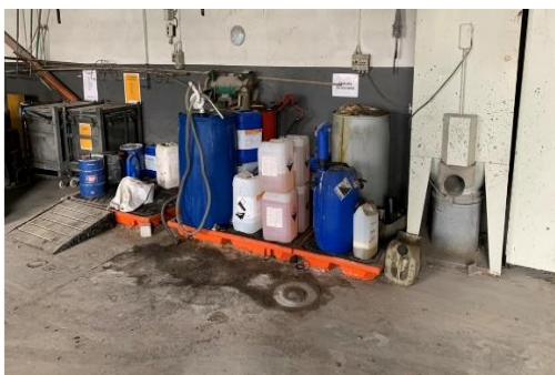
Foto af oplag af diverse miljøfarlige kemikalier og olier på spildbakke. Abas containerne kan ses til venstre på billedet, samt billedet til højre. Tomme spraydåser opbevares i skabet til højre.
