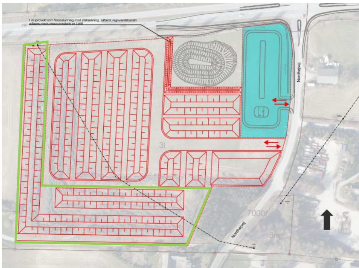
Figur 2. Oversigt over den vestlige ressourceplads, ind- og udkørsel ses med røde pile, blå markering er placering af anstillingsplads og grønne linjer viser oplag af muld fra pladsen, regnvandsbassin ses med grå markering, jordmilerne ses med rød markering.
