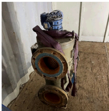
Rensningsenheder til fremtidig rensning af ballastvand (ozonenhed og filterenhed)
