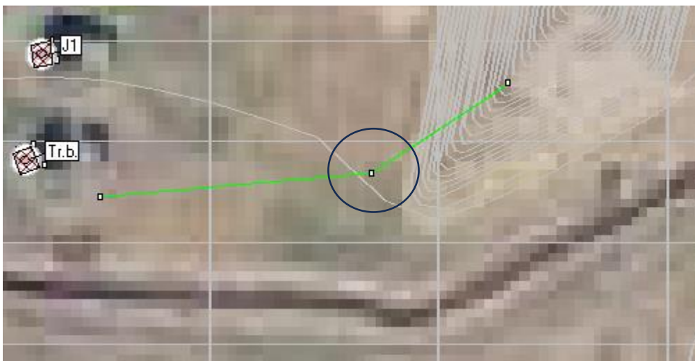
Billede 4 Grøn linje er ny jordvold for at støjdampe til modtagerpunkterne nr. M14, M15 og M16. Jordvolden starter i kote 19 tættest på Tr.b og slutter sammen med eksisterende jordvold i kote 24.5. Den nye vold når topkoten på kote 24.5 ved sort cirket og holder højden indtil nuværende jordvolde.
