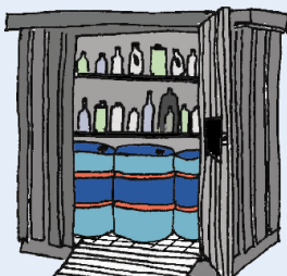
Figur 2: Udendørs opbevaring i container med dobbelt bund.
