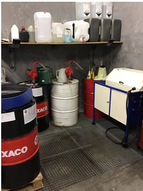
Oplag af spildolie og flydende kemikalier. Ingen afløb.
