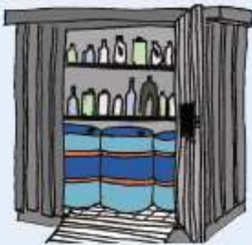
Figur 2: Udendørs opbevaring i container med dobbelt bund.
