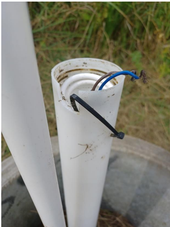
Figur 8. Monitoringsboring DGU 26.6464. Øverst tv: Boringens omgivelser. Øverst th: Boringsskilt fastgjort til filterør. Nederst tv: Knækket top på filterør. Nederst th: Skrabemærker i jorden foran DGU 26.6464. Området foran boringen udgør Nordværks sorteringsplads.
