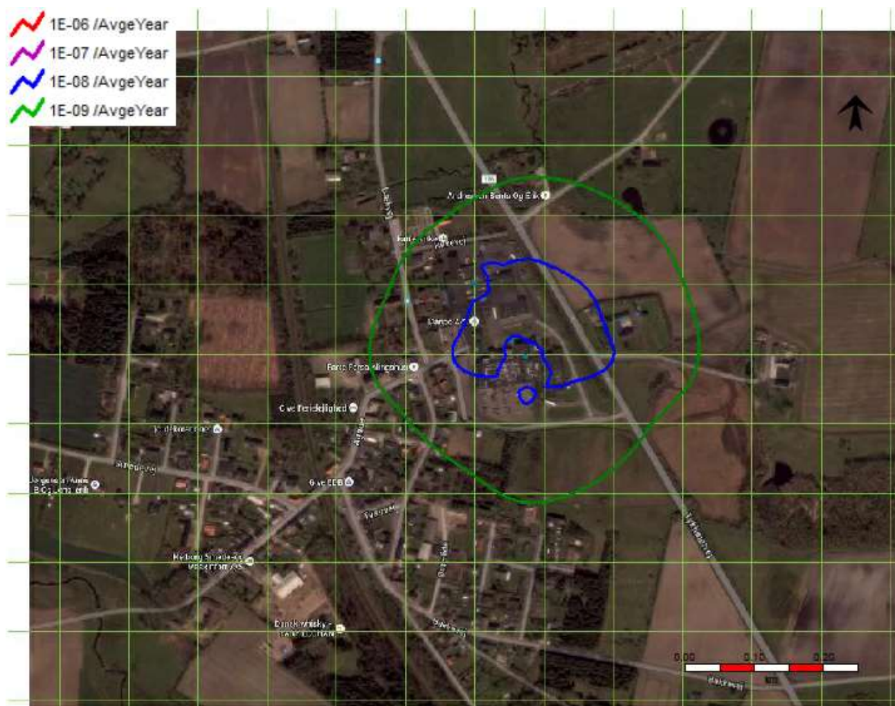
Bilag 7: Stedbunden risiko ifølge beregning baseret på udslipshyppigheder efter barrieredia-grammer ( 10^{-6} per år for hver scenarie)
