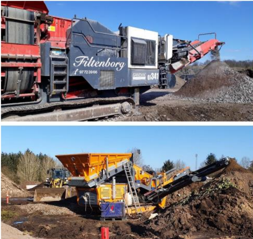
Figur 1. Øverst: Knuser. Sandvik QJ 341 Nederst: Harpe. Portafill 5000 CT
