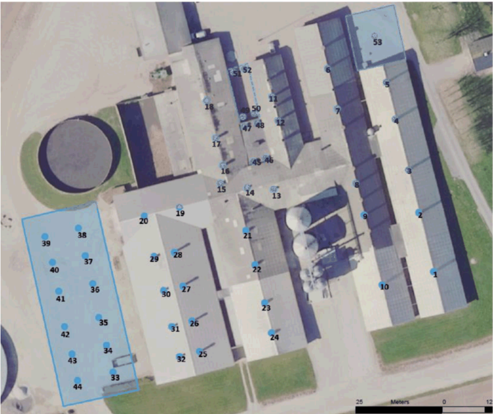
Figur 2: Placering af ventilationsafkast
