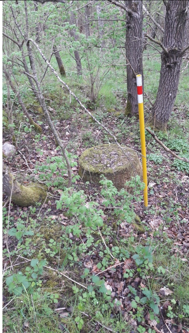
En af de oprindelige monitoringsboringer Boringen står i tæt bevoksning i randen af lossepladsens nordvestlige del.
