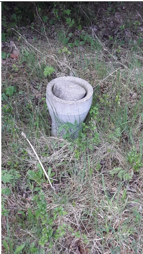
Boringen er etableret i 2013 i forbindelse med miljøkonsekvensvurderingen. Boringen er ført ned i affaldslaget.
