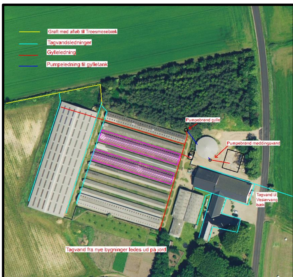
Figur 5. Afløbsforhold på anlægget.
