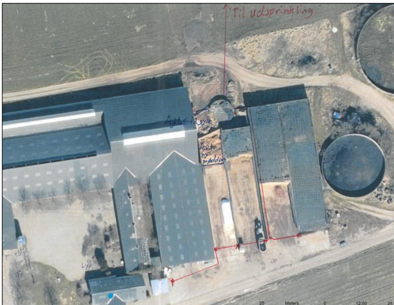
Figur 2. Afløbsplan for vand fra ensilagesiloer, vand fra mødding vil fremover blive ledt til gyllekanalerne.
