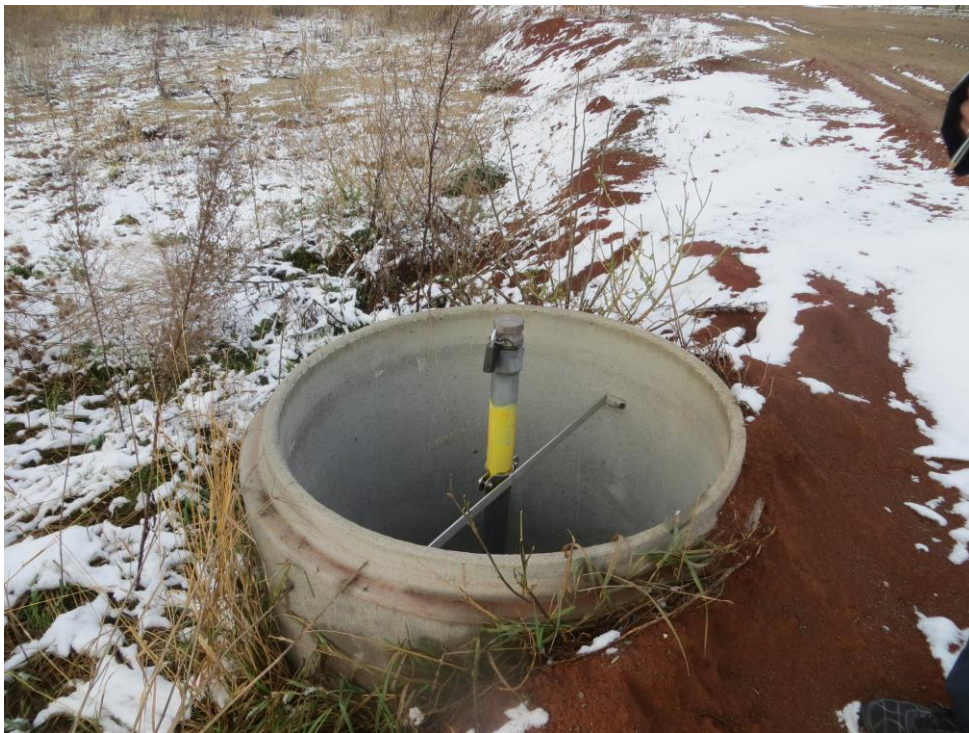
Afløst og afmærket perkolatboring. Anvendes til pejling og til prøvetagning.
