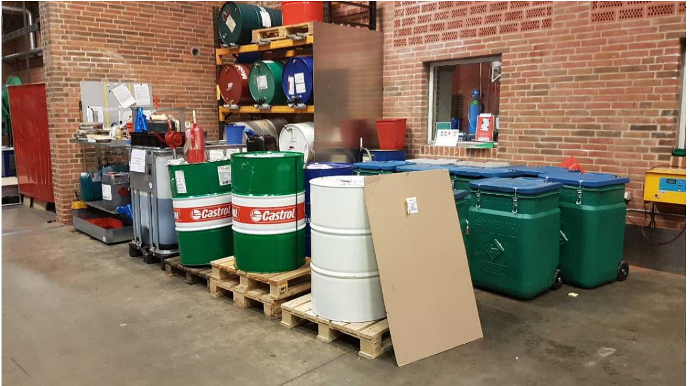
Opbevaring af flydende råvarer og kemikalier samt miljøklude i plastcontainere.
