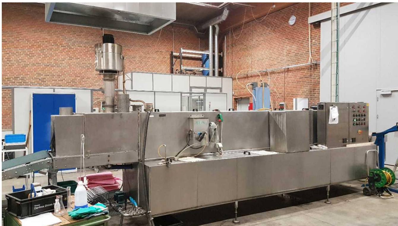
Vasketunnel til vask/affedtning af metalemner.
