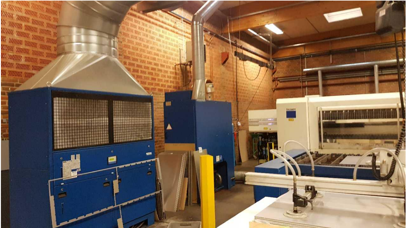
Filteranlæg samt køleanlæg ifm. laserskæring.
