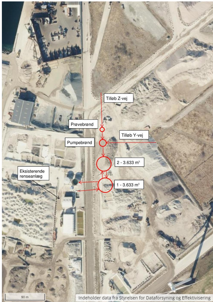
Figur 2 - Afløbsskitse for nye regnvandstanke til Y-vej og Z-vej, med tilhørende prøve- og pumpebrønde.
