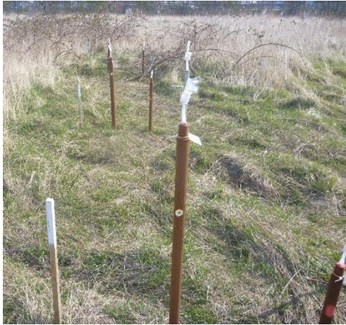
Foto 11: Sonde på enhed 1C til måling af ændring i koncentrationer af gas i det underliggende affald.
