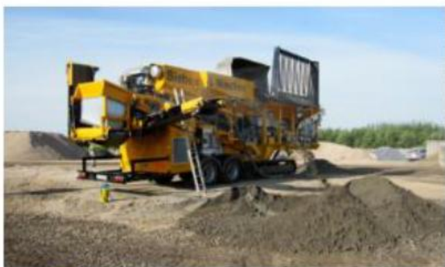
Foto: Kalkstabiliseringsanlæg- Backers anlæg 3-mtbc
