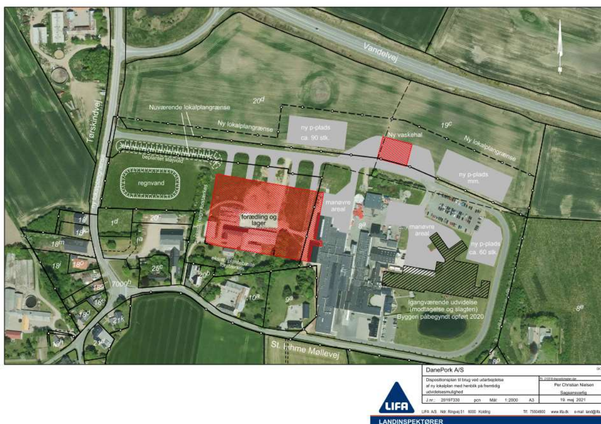
Figur 1.1: Dispositionsplan fra Projektbeskrivelse for udvidelse af aktiviteter ved Danepork/1/. Bassinet i det sydøstlige hjørne udvides, og forsinkelsesvolumen øges ved at supplere med en grøft syd for "forædling og lager".
