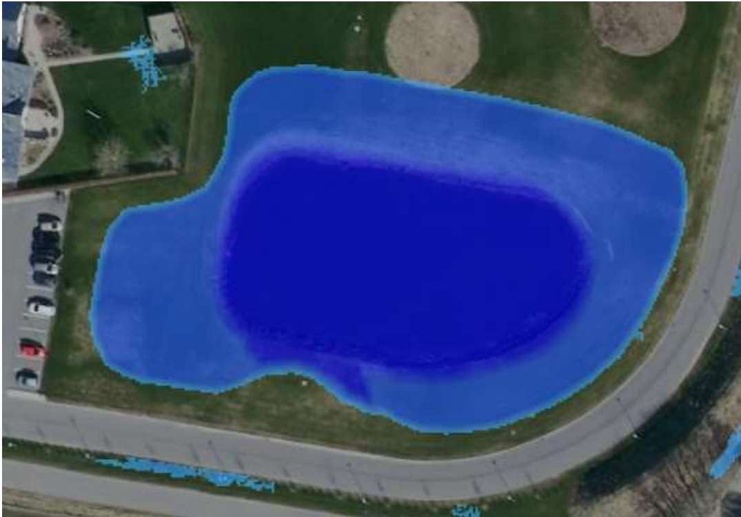
Figur 3.1: Udbredelse af vandspejl på simuleret forsinkelse af en 10-årshændelse, simuleringen er baseret på opstuvning fra et permanent vandspejl i kote 79.95 m DVR90 til top af brink.
