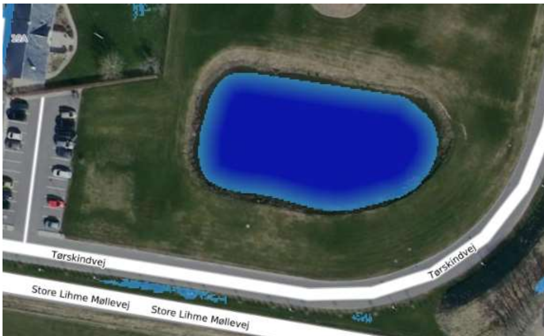
Figur 3.2: Udbredelse af vandspejl på et simuleret vådvolumen svarer til udbredelsen set på luftfoto 2020. Dog skal der tages forbehold for at udbredelse på luftfoto kan være udtryk for opstuvning efter en regnhændelse.
