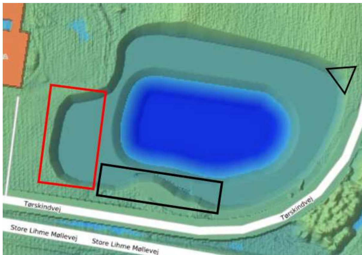
Figur 1: Oprindeligt bassin design for udvidelse af eksisterende bassin. Simuleringen ændres så den vestlige brink trækkes mod øst (område markeret med rød firkant), brinker i nordøstligt hjørne og sydlig del af bassin flyttes ud mod Tørskindvej (markeret med sort), og hele plateauet sænkes, så det er i samme højde som vandspejlet i søen.
