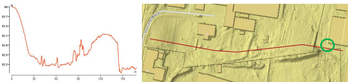
Figur 5.2: Tværsnit af terrænet. Enkelte steder ses terrænet i kote 82 m, hvilket vil give udfordringer med at skulle lave brinker over terræn. Samtidig vil der være krav til sokkelkoterne i det planlagte byggeri, som skal være betydelig højere. Tilkobling til det eksisterende afløb er markeret med grøn ring.
