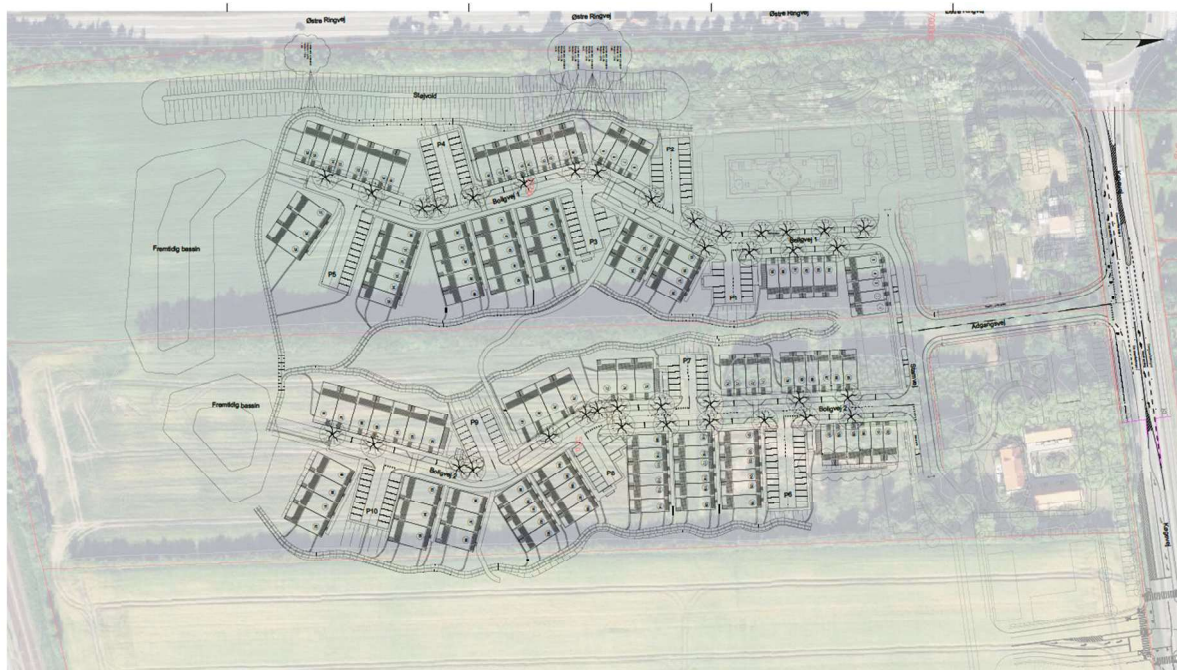
Figur 1 Oversigtsplan, hvor støjvolden er vist øverst i billedet.
