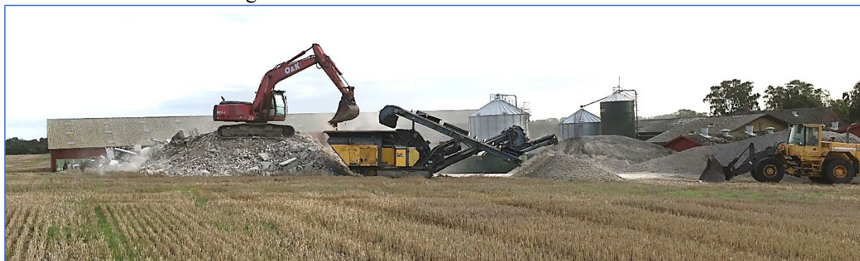
Figur 2 Foto af nedknusningsprocessen
