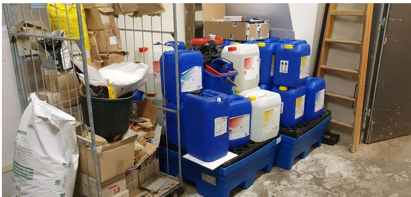
Rengøringskemi opbevares på spildbakker i et lille værkstedslokale.
