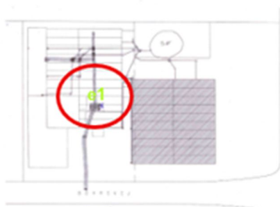
e1 Sandfang og olieudstiller i Store Hal produktion – tømmes en gang årligt
