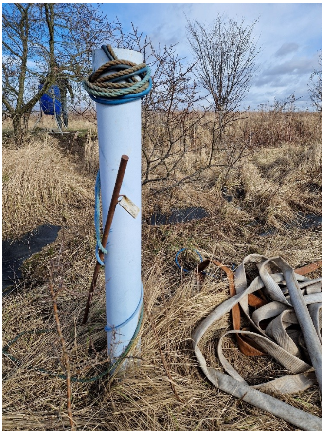
Foto nr. 5. Foto af grundvandsboring DGU- nr.200.3900. I boringen sidder en pumpe fast og der kan ikke udtages vandprøver til analyse.
