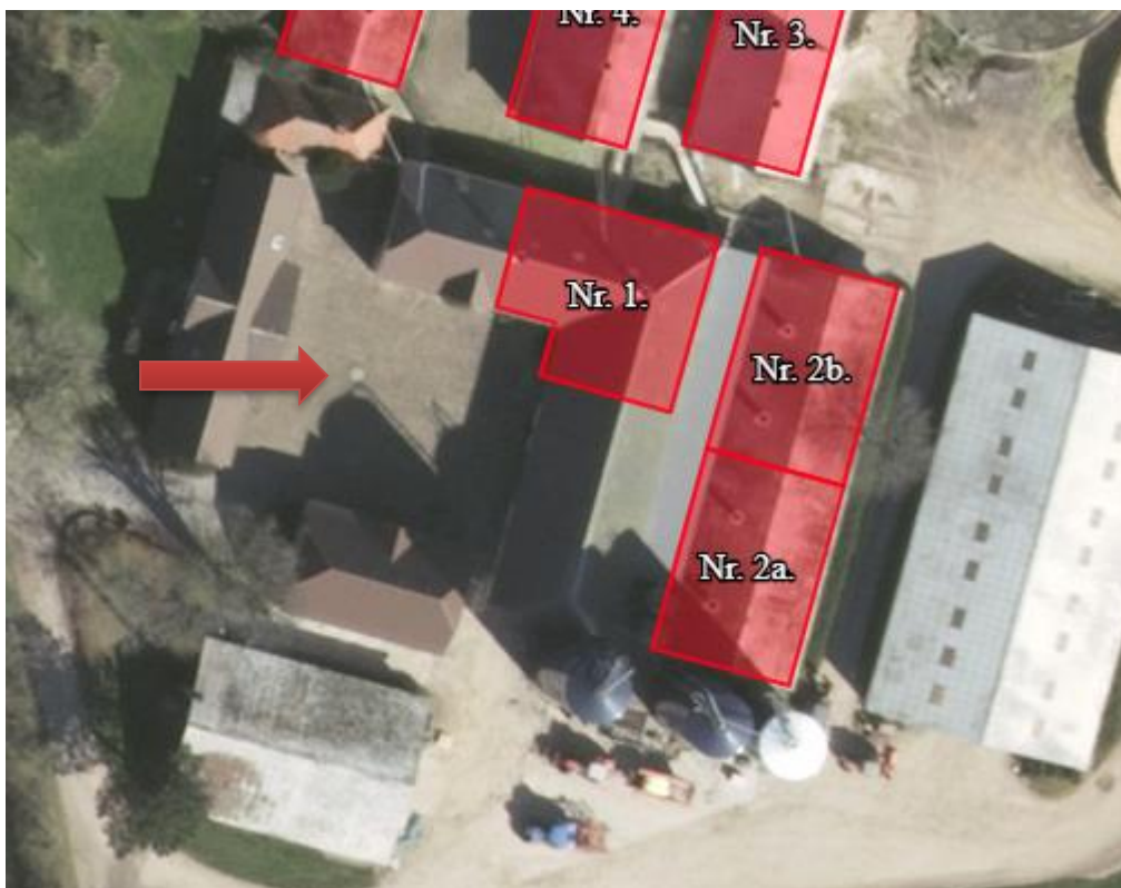
Kortudsnit fra husdyrgodkendelse.dk med placering af brønd til vand til bedriften og cirka 14 m til nærmeste staldafsnit.
