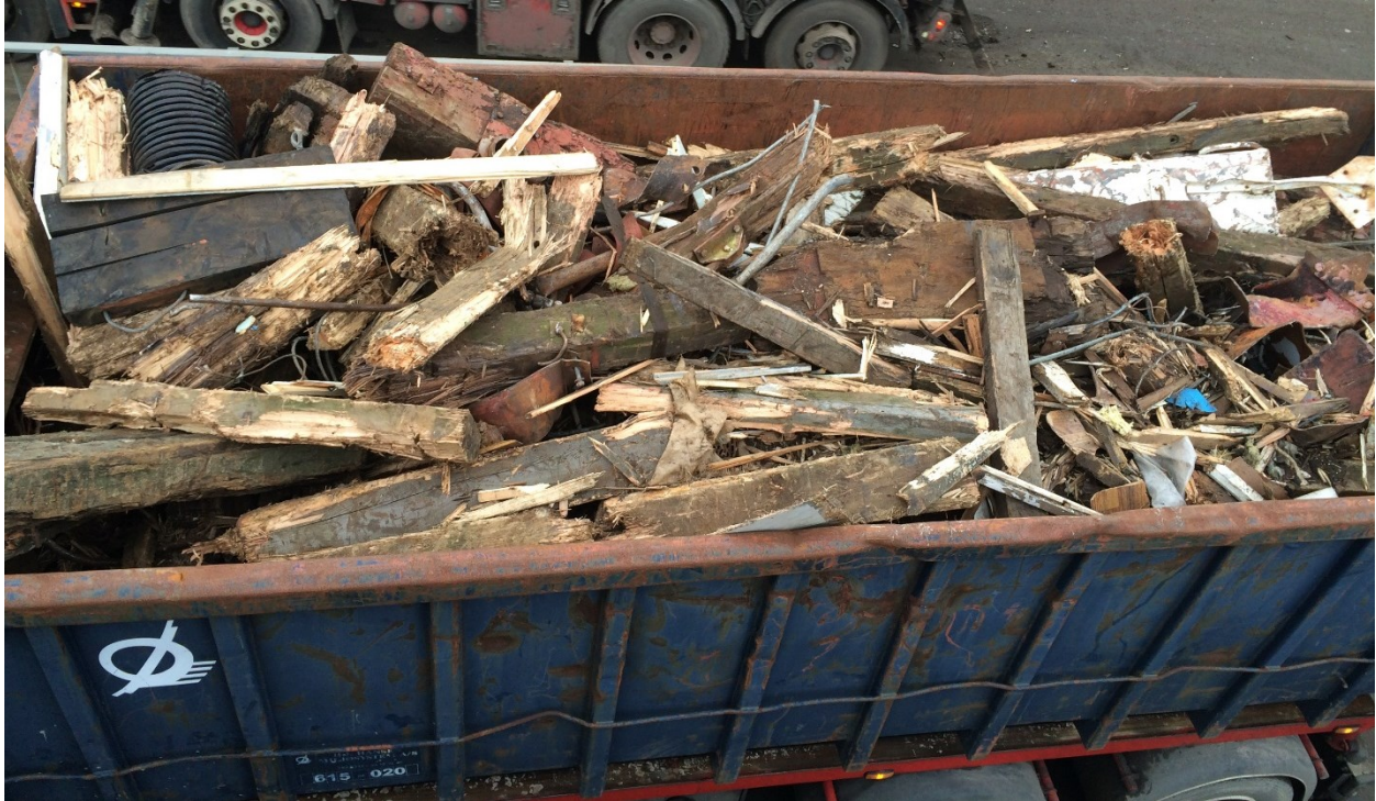
Figur 1 Viser eksempler på et læs (dette afvist pga. ringe indhold af jern), hvorfra kvalitetsvurderingen foretages.
