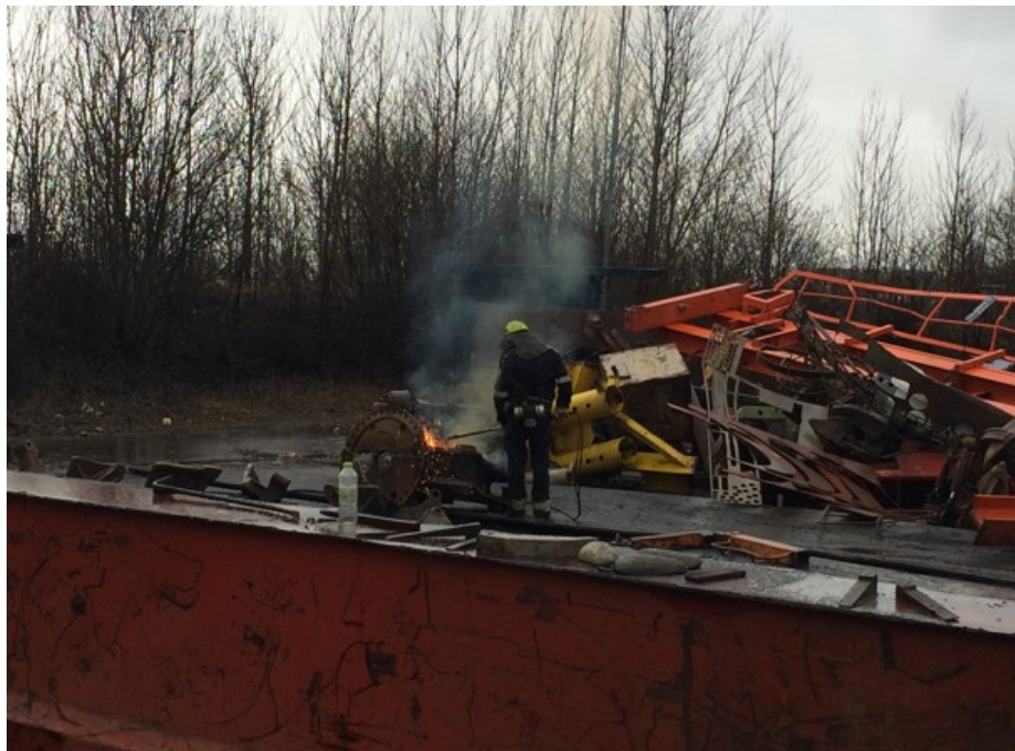
Figur 2 Viser en typisk skæringsproces, manden på billedet har luftforsynet åndedrætsværn. Opskærte varer sendes enten videre som færdigvarer eller som shredderformateriale.
